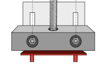
7. Если одной прокладки не хватает, добавьте еще. Таким способом достигается геометрия последней доски. Для настройки шины в горизонте положите на шину
